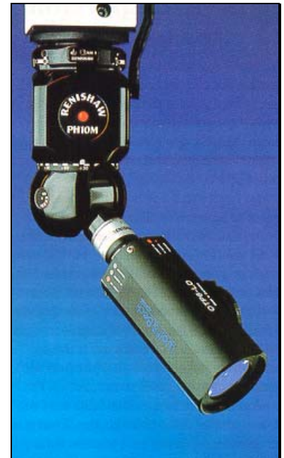
Métrie optique : Sans contact, avec une précision inférieure au \mu\text{m} .
