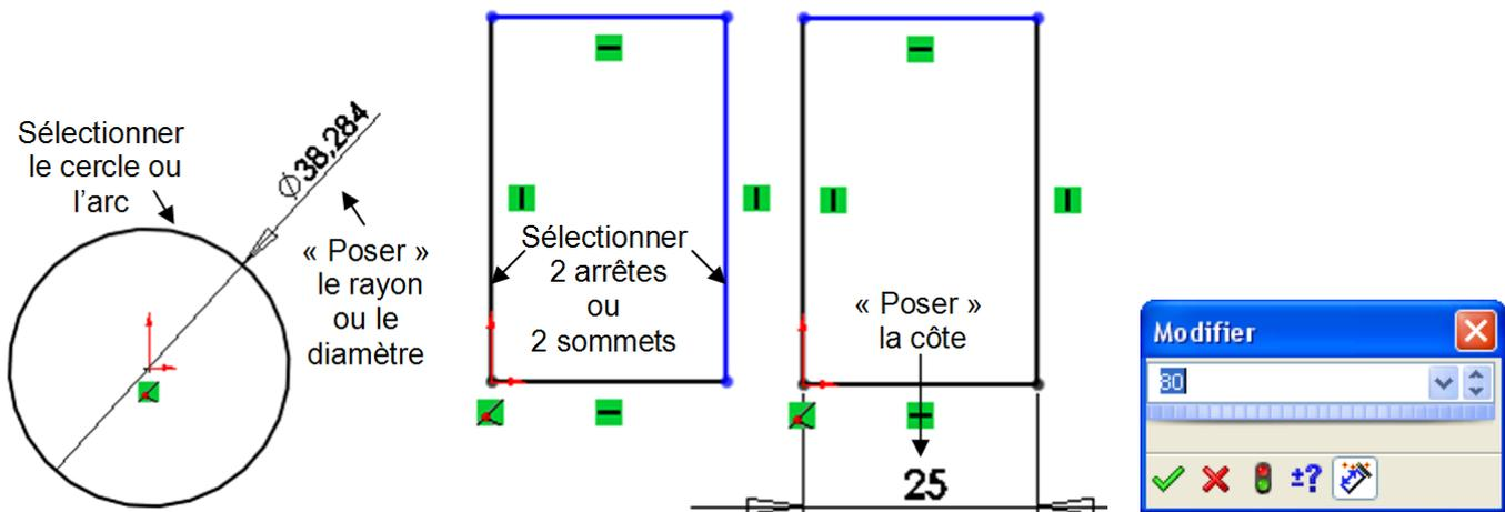
Cette possibilité permet d'optimiser le temps de création du contour, puisque l'on peut esquisser sa forme sans se soucier des dimensions puis d'ajouter des relations et les côtes nécessaire pour obtenir la taille désirée et ainsi contraindre totalement l'esquisse.
