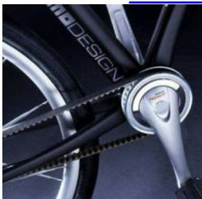
On peut également transmettre le mouvement de rotation par obstacles indirectes, en se servant d'un lien de transmission qui peut être une **chaîne** ou une **courroie crantée** sur une roue dentée.
