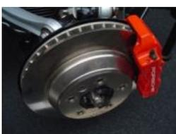
Les **freins** permettent de ralentir ou de stopper le mouvement d'un mécanisme par transformation de l'énergie mécanique en énergie calorifique.
