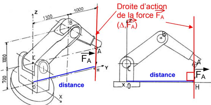
$$M_{Ox}(\vec{F}_A) = \pm (\|\vec{F}_A\| \times OH) \text{ ou } \pm (OH \times \|\vec{F}_A\|) \text{ ou } \pm (d \times \|\vec{F}\|)$$
