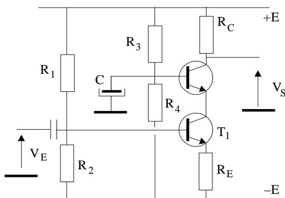
Calculer le gain en tension et les impédances d'entrée et de sortie. Déterminer la valeur des éléments du montage pour avoir un gain de 20 dB.
