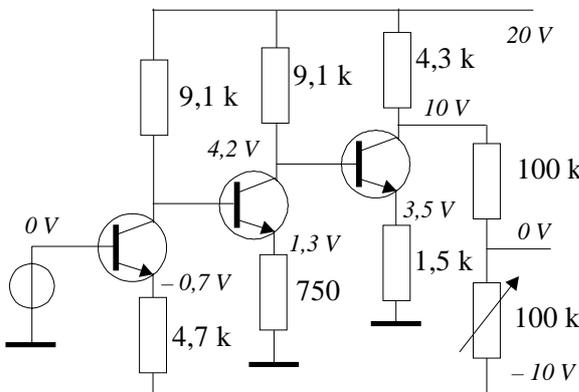
Vérifier à partir du schéma les valeurs des potentiels continus et montrer que le gain de l'ensemble est voisin de 35. (Le pont diviseur ajustable en sortie permet de fixer le potentiel de sortie à 0V en l'absence de signal sur l'entrée).
