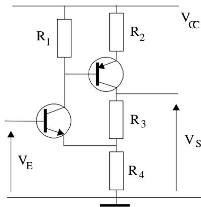
Calculer l'impédance d'entrée, le gain en tension et l'impédance de sortie. On donne :
