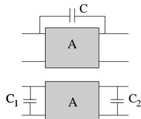
On considère le circuit *a* dans lequel le quadripôle est un amplificateur de gain en tension  $A$  dont l'entrée et la sortie sont shuntées par le condensateur  $C$ .
